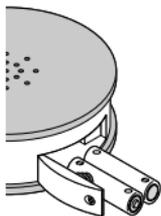
1. Dévissez la vis et relevez le couvercle du compartiment à piles.
