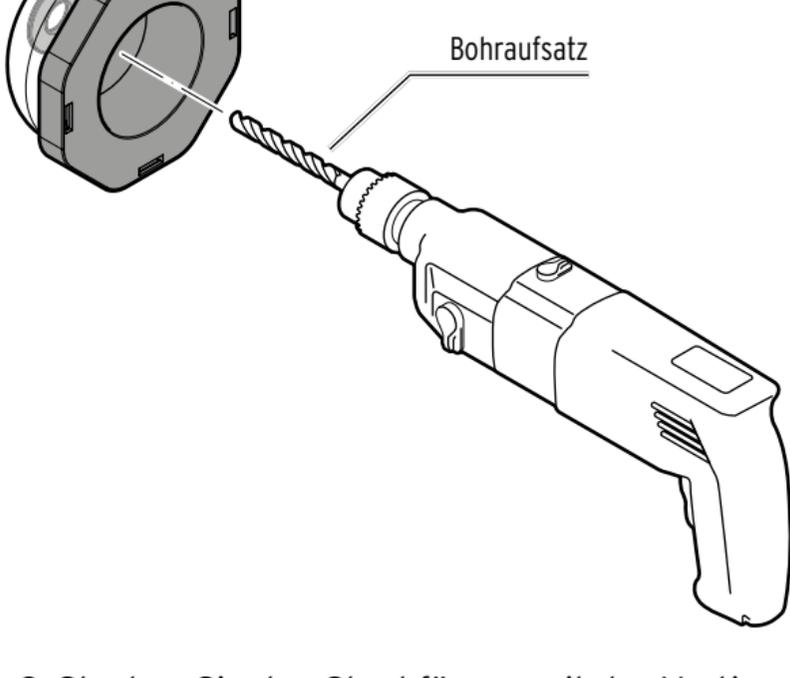
3. Stecken Sie den Staubfänger mit der Vertiefung voran auf den Bohraufsatz.
