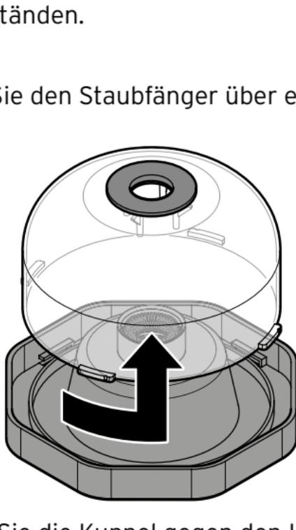
2. Drehen Sie die Kuppel gegen den Uhrzeiger-sinn und nehmen Sie sie ab.
