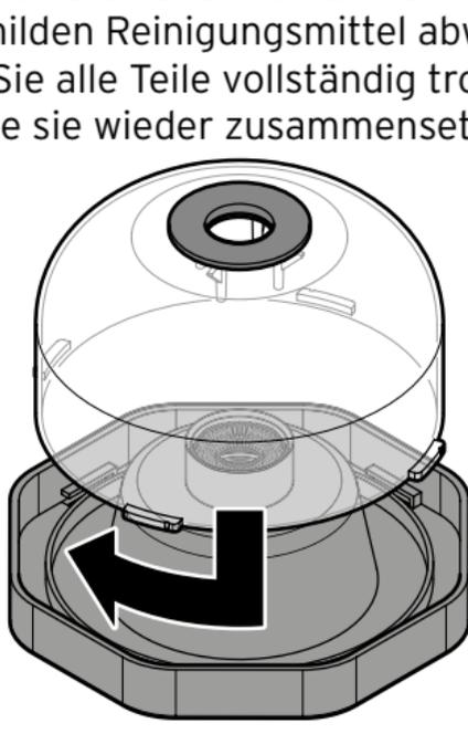
4. Setzen Sie die Kuppel wieder auf und drehen Sie sie im Uhrzeigersinn, um den Staubfänger wieder zu verschließen.
