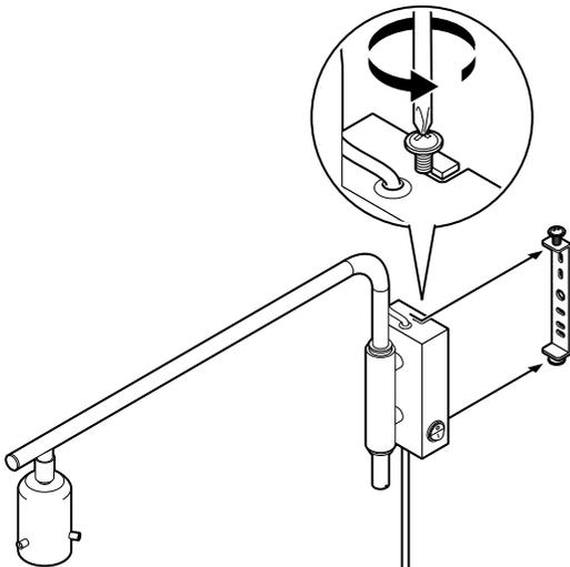
1. Dévissez les deux vis situées sur et sous le support du luminaire et fixant l'étrier de montage mural au luminaire jusqu'à ce que vous puissiez retirer l'étrier.
