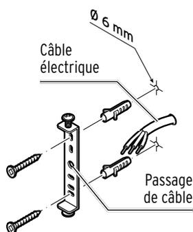
2. Passez les fils électriques dans le passage de câble de l'étrier de montage mural. Fixez l'étrier au mur en vous servant des chevilles et des vis.
