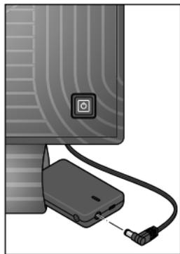
1. Enfichez le cordon d'alimentation du coussin de siège chauffant dans la prise de raccordement correspondante de la batterie.
