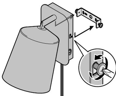
1. Dévissez les deux vis de fixation latérales avec lesquelles l'étrier de fixation murale est fixé au luminaire, jusqu'à ce que vous puissiez retirer l'étrier de fixation murale.
