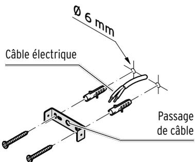
5. Passez les fils électriques dans le passage de câble de l'étrier de fixation. Fixez l'étrier au mur en vous servant des chevilles et des vis.
