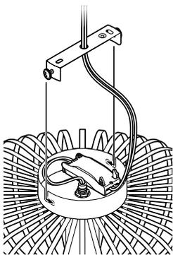
1. Rangez le cordon d'alimentation et le connecteur auto-débrayable dans le cache-fils et faites glisser le cache-fils vers le haut sur l'étrier de plafond. Resserrer les vis à fond.
