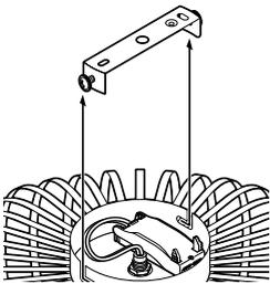
2. Dévissez les deux vis latérales fixant l'étrier de plafond au cache-fils jusqu'à ce que vous puissiez retirer l'étrier.
