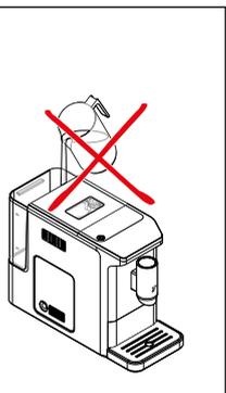
4. Riempire il serbatoio dell'acqua con acqua di rubinetto o acqua potabile fredda fino alla marcatura del livello MAX. **Non aggiungere acqua direttamente nel serbatoio se questo è ancora inserito nella macchina!**
