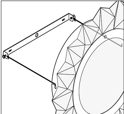
Dévissez les deux vis latérales fixant l'étrier au luminaire jusqu'à ce que vous puissiez retirer l'étrier.
