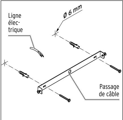
Passez les fils électriques (câble de plafond) dans le passage de câble de l'étrier de fixation. Fixez l'étrier de fixation au mur ou au plafond en vous servant des chevilles et des vis.
