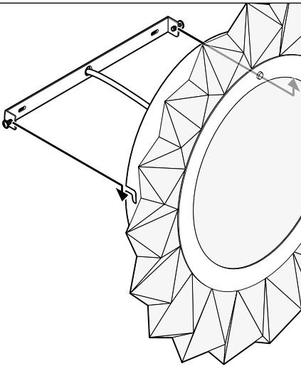
Faites glisser le luminaire avec les fentes sur les vis de l'étrier de fixation.
