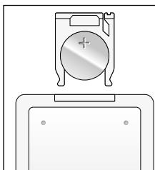
Remplacez la pile usée par une neuve en respectant impérativement la bonne polarité. Le pôle positif (+) doit être en haut.
