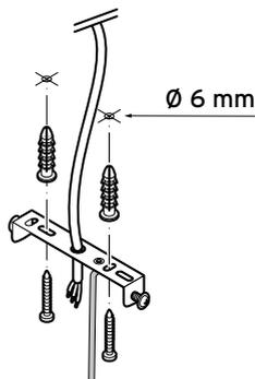
6. Passez les lignes électriques (câble de plafond) dans le passage de câble de l'étrier de fixation. Fixez l'étrier de fixation au plafond en vous servant des chevilles et des vis.
