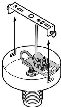
3. Dévissez les deux vis latérales fixant l'étrier au cache-fils jusqu'à ce que vous puissiez retirer l'étrier.
