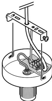
2. Engagez le cache-fils sur les deux vis de fixation de l'étrier de fixation, légèrement vissées.
