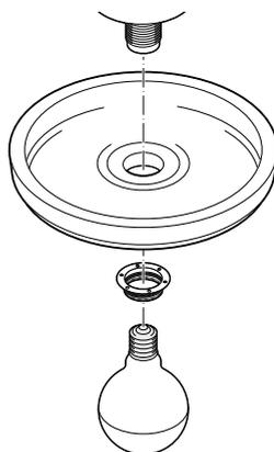
4. Passez la base de la lampe sur la douille et vissez la bague filetée sur la douille.
