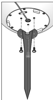
6. Fixez l'autre piquet sous la lampe solaire d'extérieur à l'aide des vis fournies.
