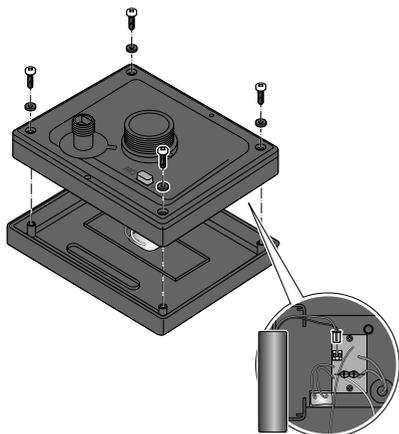
3. Desserrez les vis sur la face inférieure du module solaire avec un tournevis cruciforme et retirez le cache.
