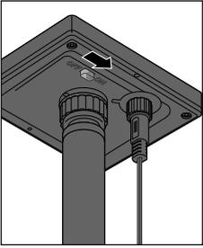
▷ Mettez l'interrupteur marche/arrêt situé sur la face inférieure du module solaire sur **ON** pour activer la lampe solaire d'extérieur.
