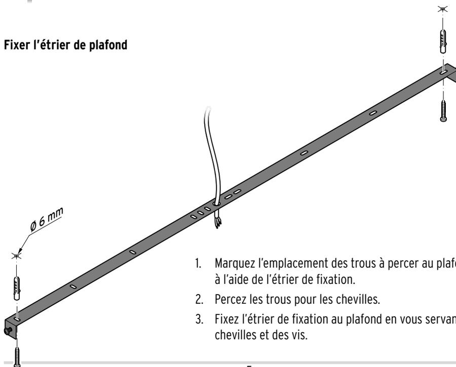
1. Marquez l'emplacement des trous à percer au plafond à l'aide de l'étrier de fixation.
