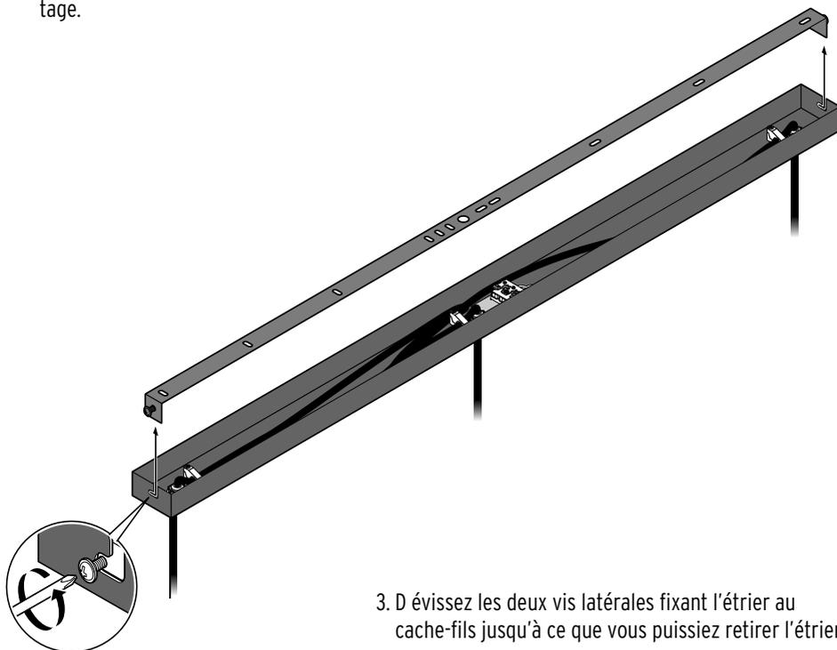
3. D'évissez les deux vis latérales fixant l'étrier au cache-fils jusqu'à ce que vous puissiez retirer l'étrier.
