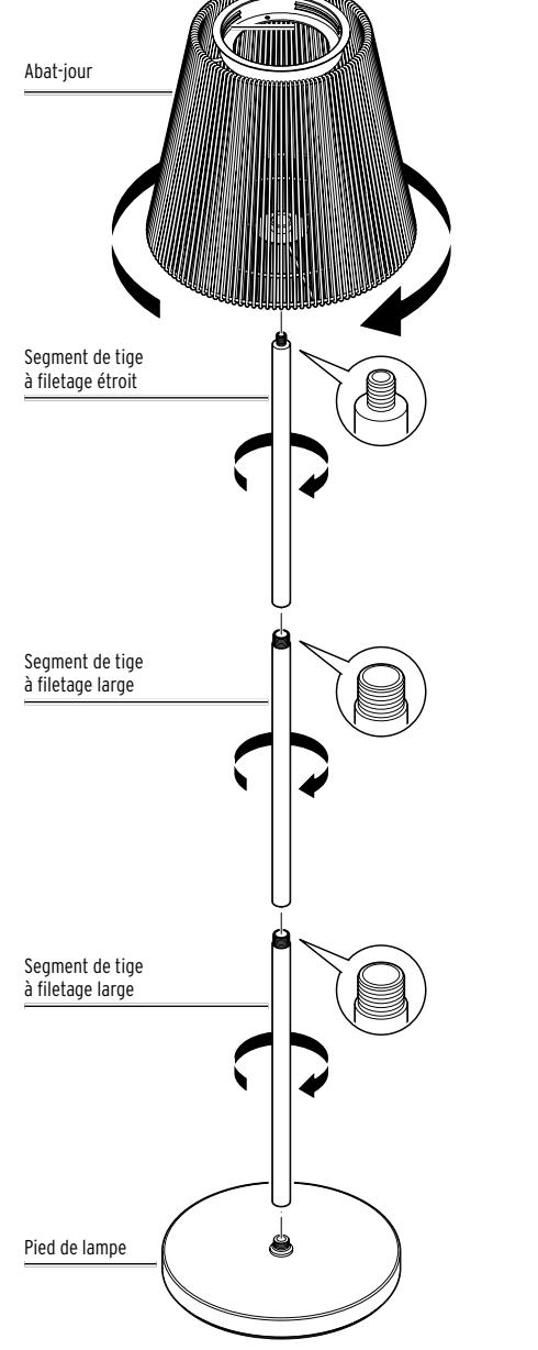
▷ Montez le luminaire conformément à l'illustration.
