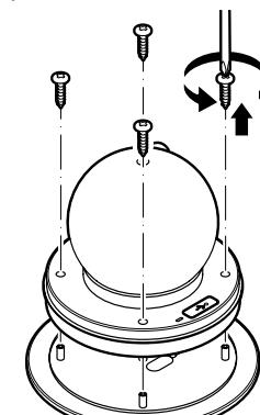
3. Desserrez les 4 vis de la tête du luminaire à l'aide d'un tournevis cruciforme et retirez prudemment la tête du luminaire. Faites attention à ne pas arracher de câbles!
