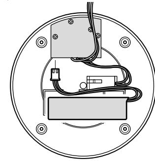
4. Débranchez le connecteur du câble de raccordement de la prise du circuit imprimé, conformément à l'illustration, et retirez la batterie de son support.
