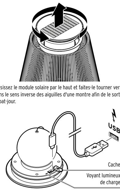
1. Saisissez le module solaire par le haut et faites-le tourner vers le haut dans le sens inverse des aiguilles d'une montre afin de le sortir de l'abat-jour.
