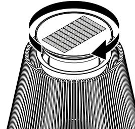
5. Remettez dans l'abat-jour le module solaire avec la tête du luminaire et vissez-le dans le sens des aiguilles d'une montre.
