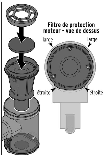
5. Replacez le filtre de protection moteur en premier. Le filtre de protection moteur ne se remet correctement en place que dans une position: les encoches étroites doivent être orientées vers l'avant en direction du tube et les encoches larges vers l'arrière (voir l'illustration).
