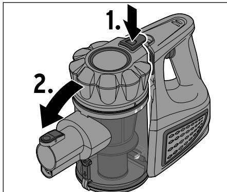
1. Appuyez sur le bouton de déverrouillage du bac à poussière (1.) et retirez le bac à poussière du bloc-moteur (2.).
