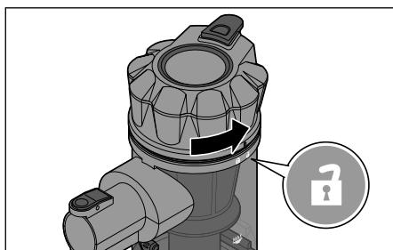
2. Tournez le cache du bac à poussière dans le sens inverse des aiguilles d'une montre en direction de pour l'enlever.
