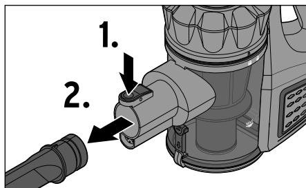
1. Appuyez sur le bouton de déverrouillage du tube ou du suceur (1.) et tirez sur le tube ou le suceur pour l'enlever du bloc-moteur (2.).
