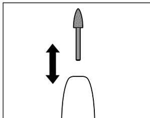
2. Retirez l'embout déjà mis et enfoncez le nouvel embout dans le logement jusqu'à la butée.
