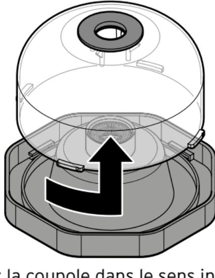
2. Tournez la coupole dans le sens inverse des aiguilles d'une montre et retirez-la.
