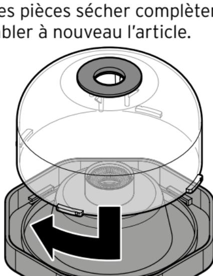
4. Remettez la coupole en place et tournez-la dans le sens des aiguilles d'une montre pour refermer le collecteur de poussière.
