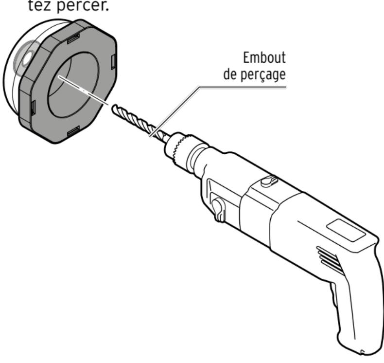
3. Placez le collecteur de poussière sur l'embout de perçage, avec l'ouverture devant.
