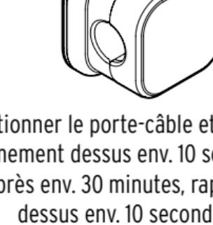
Positionner le porte-câble et appuyer fermement dessus env. 10 secondes.
