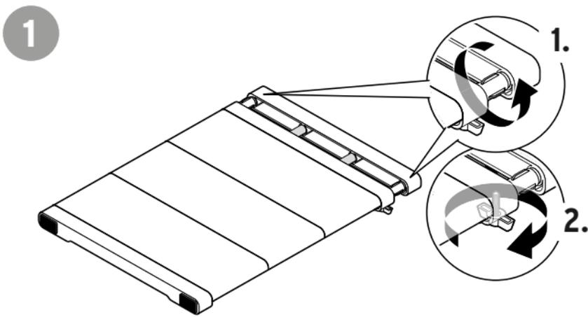
Desserrez les vis de serrage (1.) et les vis à ailettes (2.).
