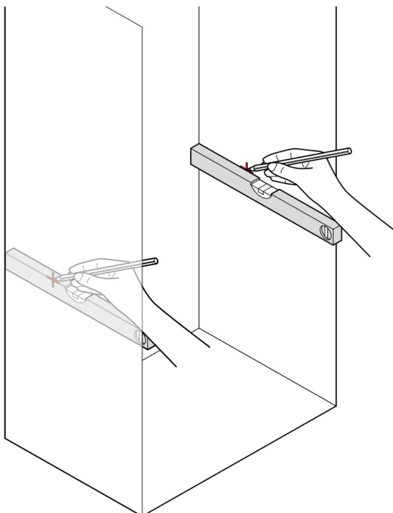
À l'aide d'un niveau à bulle, tracez un trait horizontal de chaque côté pour marquer l'emplacement des supports adhésifs.
