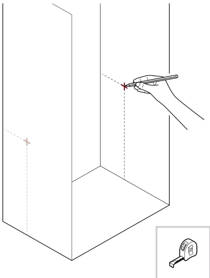
Mesurez **la hauteur et la profondeur** du marquage avec un mètre ruban/pliant et reportez-les sur l'autre côté.
